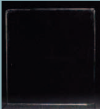
vetroClean nach dem gleichen Test: keine sichtbaren Schädigungen; der Schutz vor Glaskorrosion wirkt.
